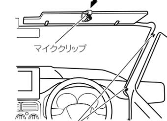
市販のクランパーなどで要所を固定しながら、運転操作に支障がないようにマイクコードを引き回します。
